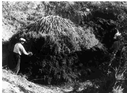
Recobrint la carbonera abans de l'encesa
