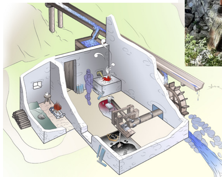
Restitució hipotètica del treball a la ferreria del Madriu (dibuix, O. Vingolte)
